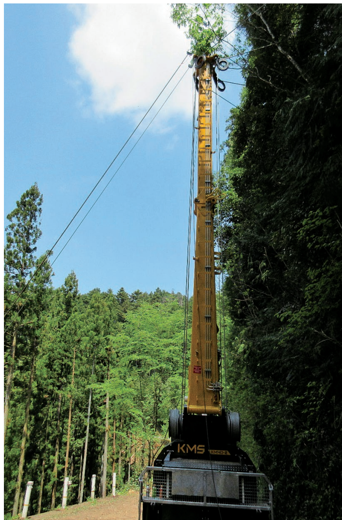
日の出町大久野地区で稼働するタワヤーダ
